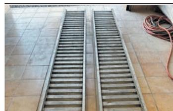
**LKW Laderampen**, 1 Paar, Alu, schwere Ausführung, Länge 4 m, Breite 42 cm, Höhe 13,5 cm, Tragkraft 5 Tonnen, gebraucht. ☎ **0049 171 8940341**
